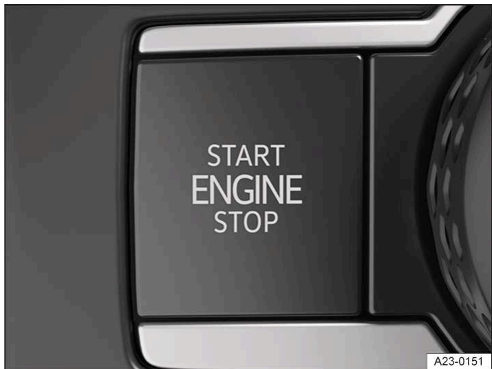
Илл. 1 В нижней части центральной консоли: кнопка пуска двигателя
