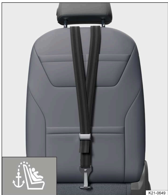
Илл. 2 На задней стороне сиденья переднего пассажира (в зависимости от экспортного исполнения): закреплённый ремень Top Tether.
