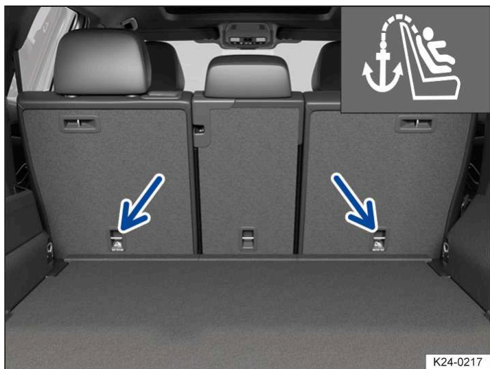
Илл. 1 С обратной стороны задних сидений: крепёжные проушины Top Tether для ремня Top Tether.
