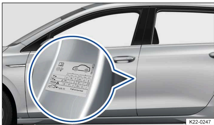
Илл. 1 На стойке двери водителя: наклейка с указанием предписанного давления в шинах (или на внутренней стороне крышки лючка топливного бака)
