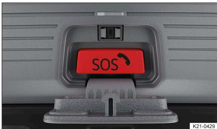
Илл. 2 В потолочной консоли: клавиша предусмотренной законом системы аварийного вызова eCall
