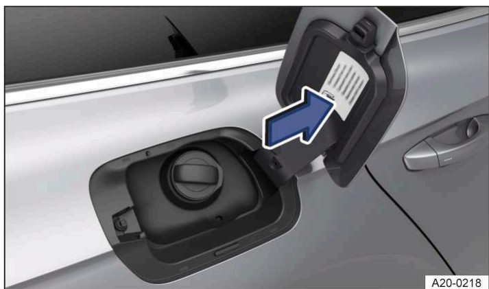
Илл. 1 Табличка с указанием разрешённых видов топлива на внутренней стороне крышки лючка топливного бака (условное изображение).
