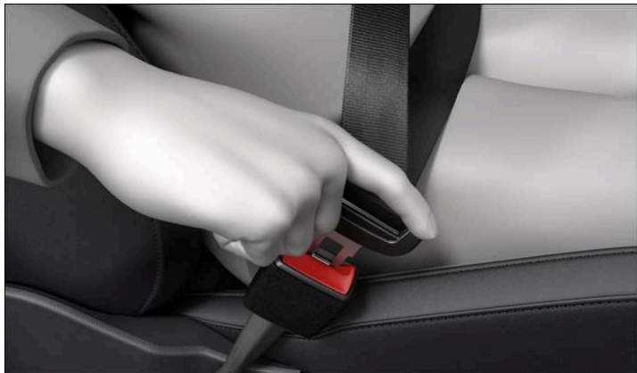
Илл. 1 Установка язычка ремня безопасности в замок ремня безопасности (условное изображение).
