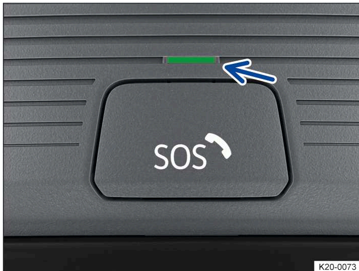
Илл. 1 В потолочной консоли: клавиша для предусмотренной законом системы аварийного вызова eCall (под крышкой) и контрольная лампа.
