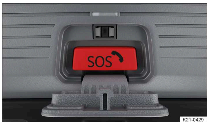
Илл. 2 В потолочной консоли: клавиша аварийного вызова
