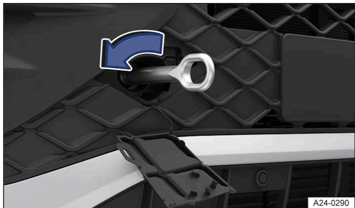
Илл. 4 На переднем бампере справа: вкрутите буксирную проушину (вариант 2).
