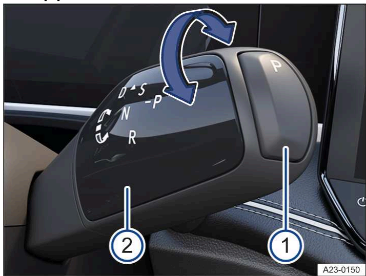
Илл. 1 На рулевой колонке справа: переключатель режимов движения автоматической коробки передач.
