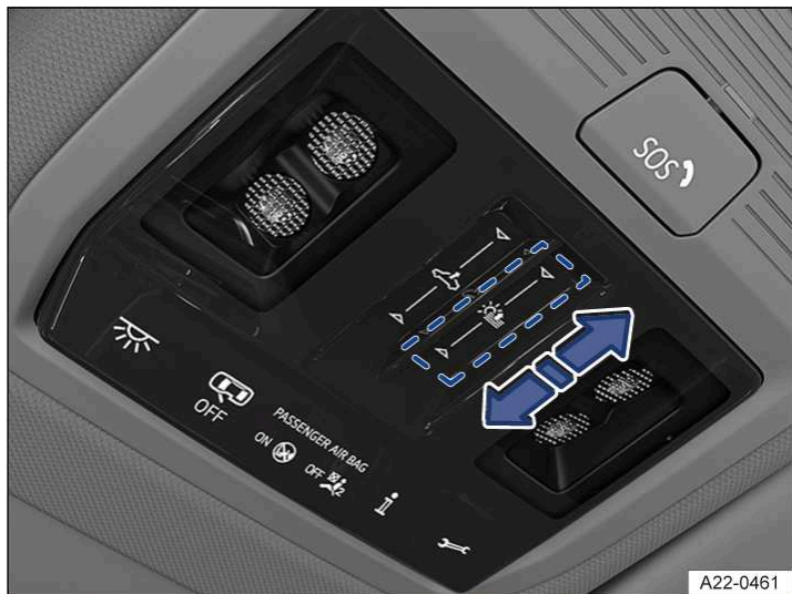
Илл. 1 В потолочной панели: экранные кнопки управления солнцезащитной шторкой
