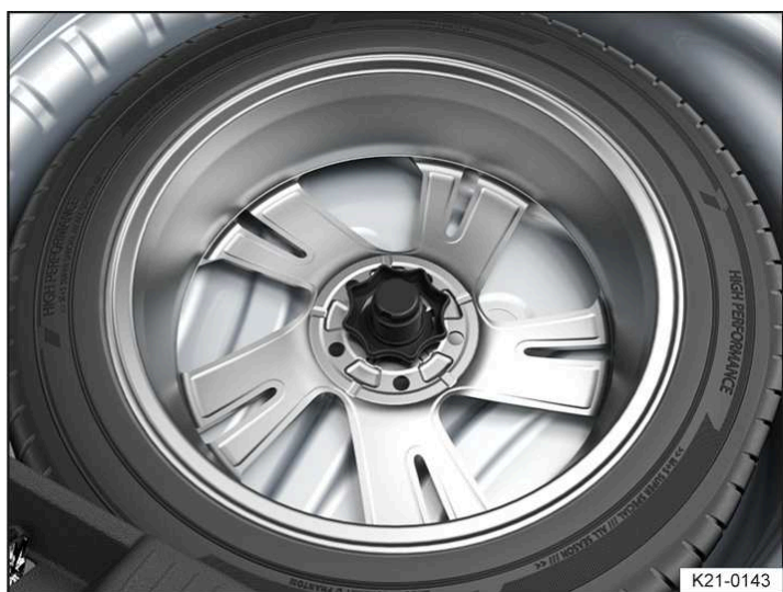
Илл. 1 Под фальшполом: маховичок для крепления запасного или докатного колеса.
