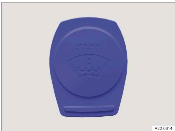
Илл. 1 В подкапотном пространстве: крышка бачка стеклоомывателя (условное изображение).
