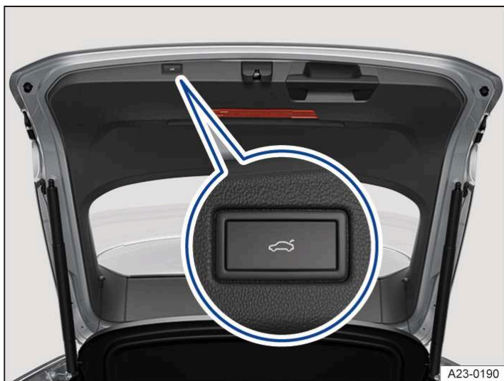
Илл. 1 В крышке багажного отсека: клавиша закрывания крышки багажного отсека с помощью электропривода
