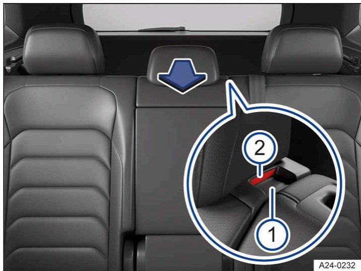
Илл. 1 Вид из салона: открывание люка для перевозки длинномерных грузов
