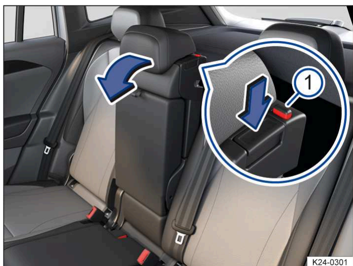
Илл. 3 Заднее многоместное сиденье: складывание и раскладывание среднего сиденья.
