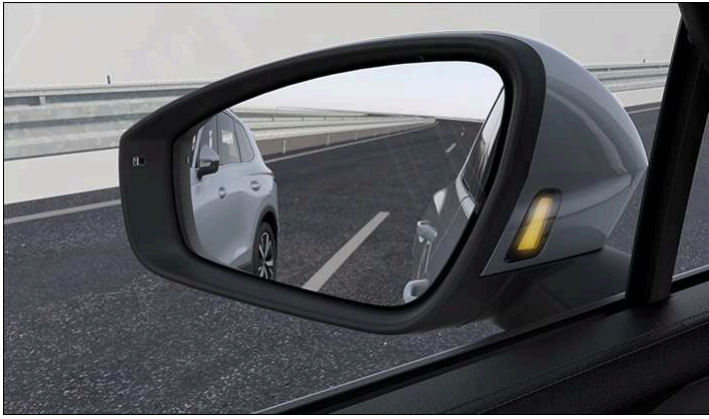
Илл. 1 В корпусе зеркала заднего вида: индикация ассистента смены полосы.
