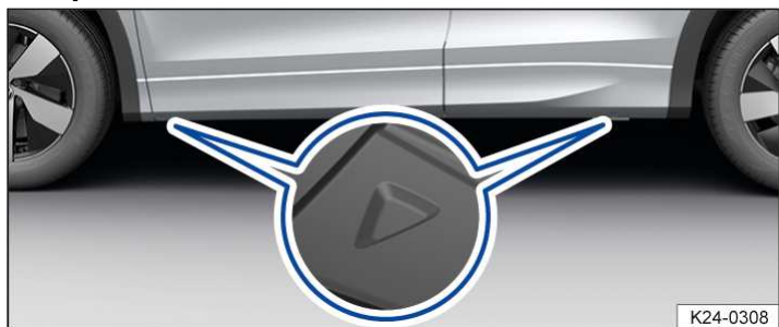
Илл. 1 На боковом пороге: отметки опорных точек для домкрата.
