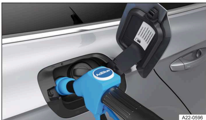
Илл. 1 Под крышкой лючка заливной горловины: пробка заливной горловины для жидкости AdBlue (условное изображение).
