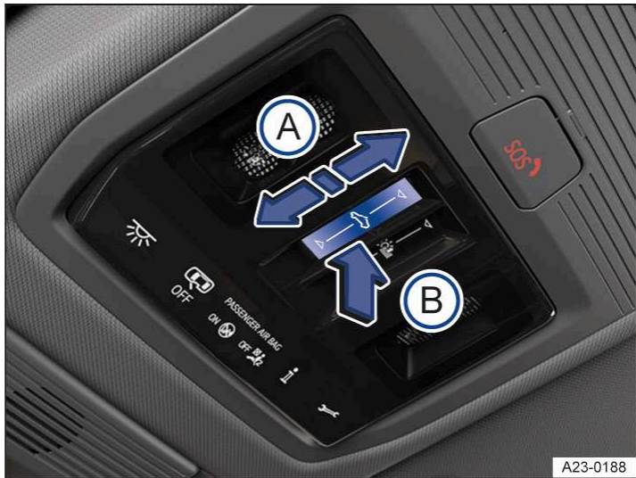
Илл. 1 В потолочной панели: сенсорная клавиша управления стеклянным люком
