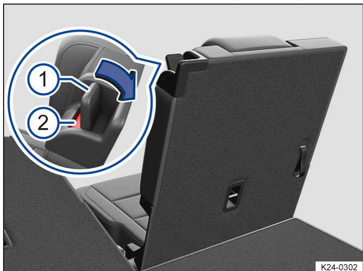
Илл. 1 Третий ряд сидений: складывание заднего сиденья для перевозки багажа
