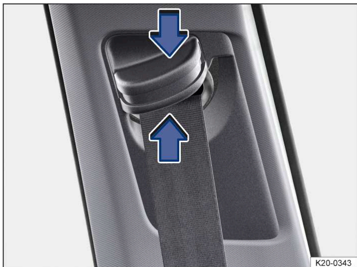
Илл. 1 Рядом с передним сиденьем: регулировка ремня безопасности по высоте.
