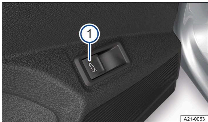
Илл. 2 На двери водителя: клавиша для открывания или закрывания крышки багажного отсека с помощью электропривода (условное изображение).
