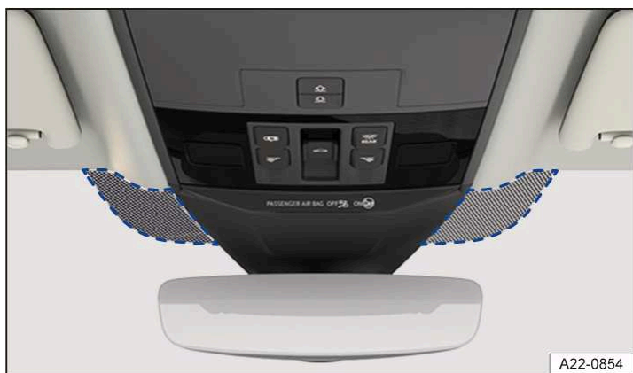
Илл. 1 Рядом с кронштейном зеркала: коммуникационное окно (условное изображение).
