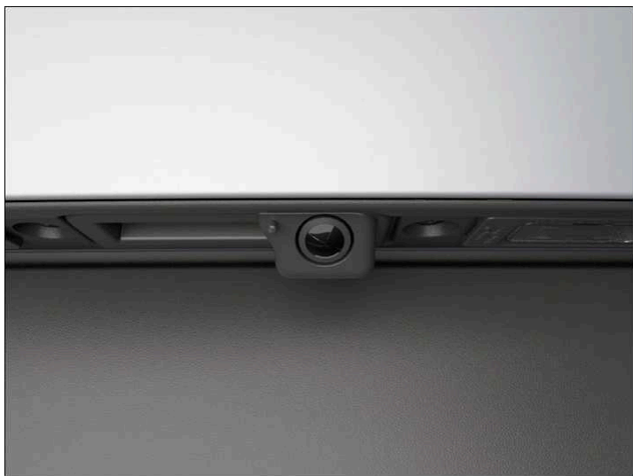
Илл. 2 В задней части автомобиля: камера заднего вида в клавише на крышке багажного отсека (условное изображение).
