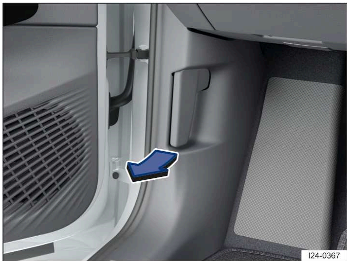
Илл. 1 В пространстве для ног водителя: рычаг отпирания капота (условное изображение).
