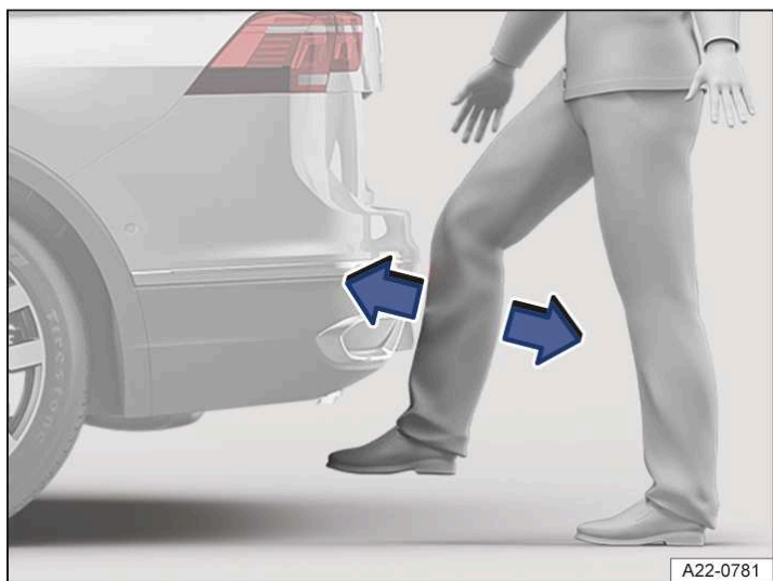
Илл. 1 Условное изображение крышки багажного отсека с автоматическим закрыванием по сигналу датчика (Easy Close)
