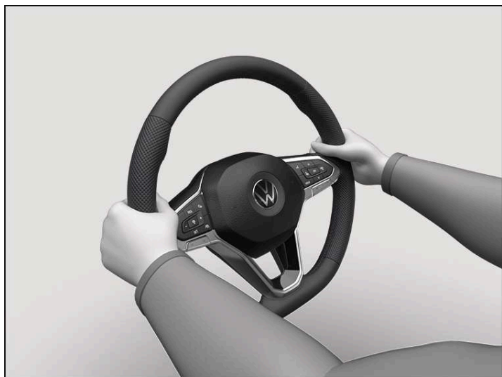
Илл. 2 На рулевом колесе: положение, соответствующих девяти и трём часам на циферблате (условное изображение).
