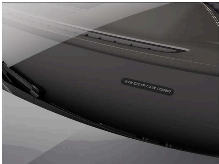
Илл. 1 В нижней части лобового стекла: идентификационный номер транспортного средства.
