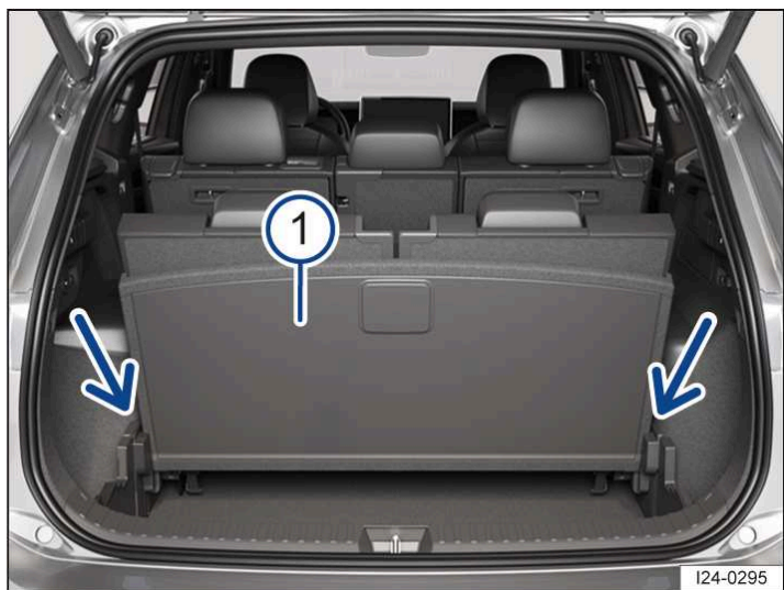
Илл. 3 В багажном отсеке: поднятый фальшпол.
