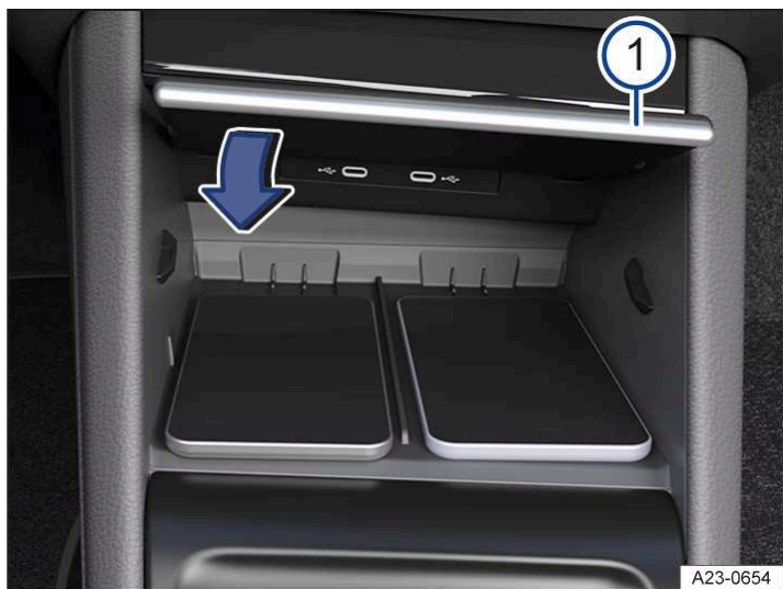
Илл. 2 В передней части центральной консоли: вещевое отделение с откидным промежуточным днищем (условное изображение).
