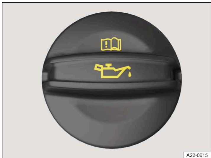
Илл. 1 В подкапотном пространстве: крышка бачка маслосливной горловины (условное изображение).
