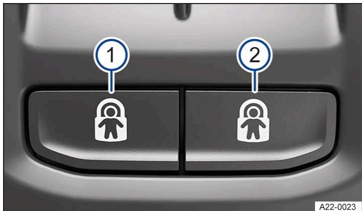
Илл. 1 На двери водителя: клавиши электрической «детской» блокировки.
