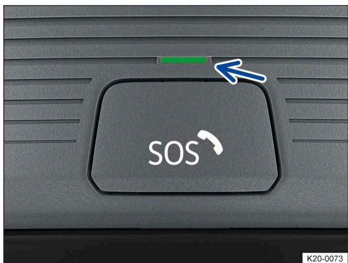
Илл. 1 В потолочной консоли: клавиша аварийного вызова (под крышкой) и контрольная лампа
