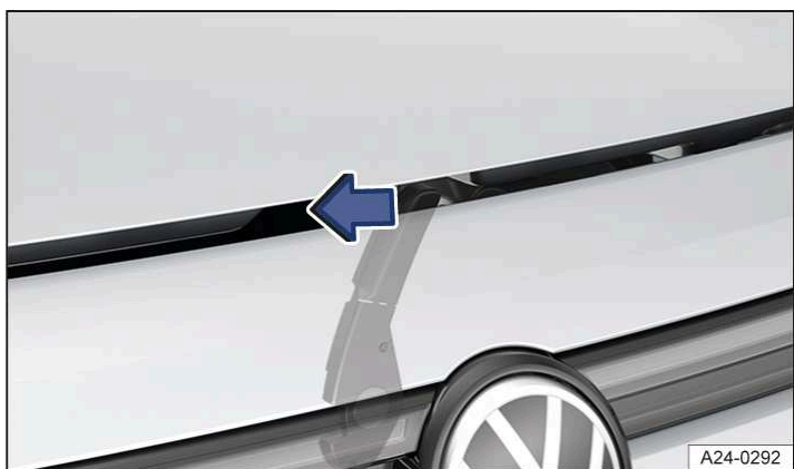
Илл. 2 Над решёткой радиатора: рычаг открывания капота.
