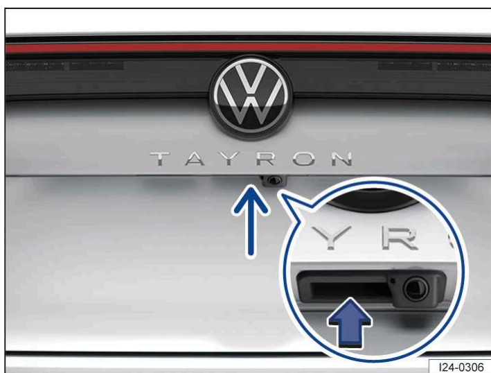
Илл. 1 В крышке багажного отсека: клавиша открывания крышки багажного отсека.
