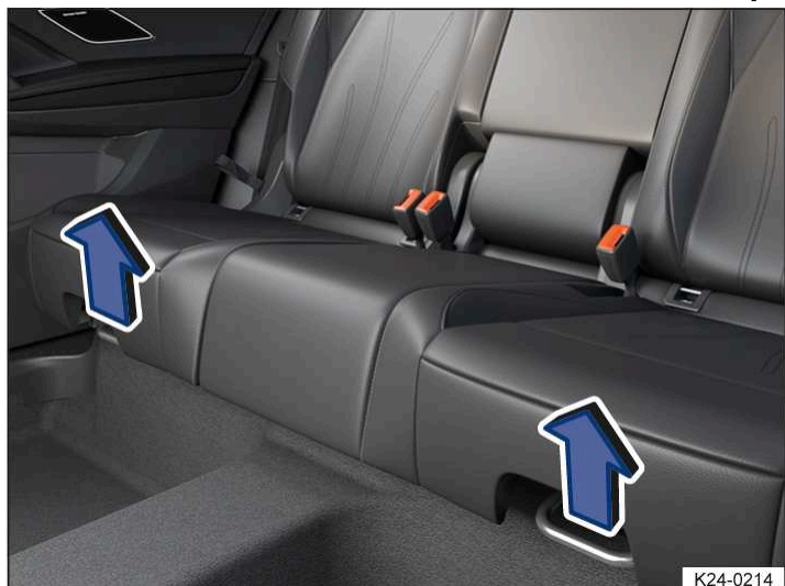
Илл. 1 Под подушкой заднего многоместного сиденья: скоба для регулировки (условное изображение).
