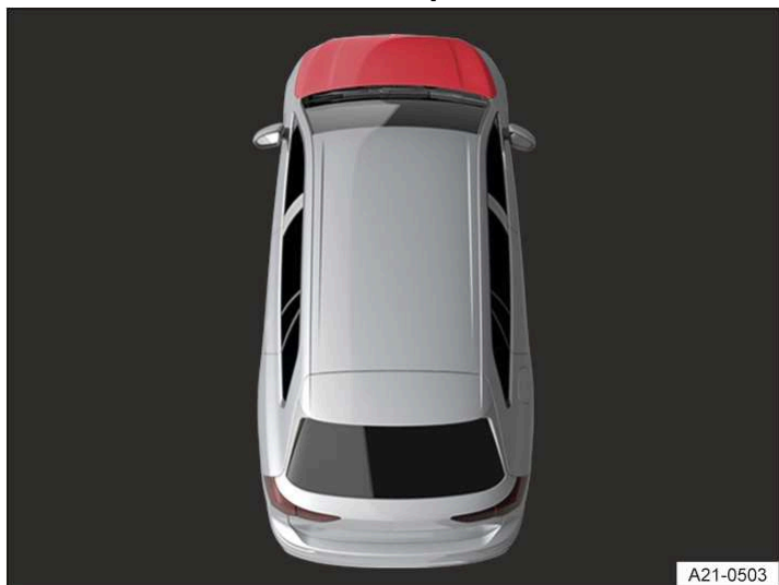
Илл. 3 На дисплее комбинации приборов: открыт или неправильно закрыт капот (условное изображение).
