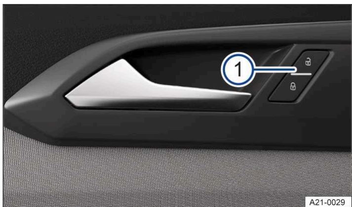
Илл. 1 На двери водителя: клавиша центрального замка (условное изображение)
