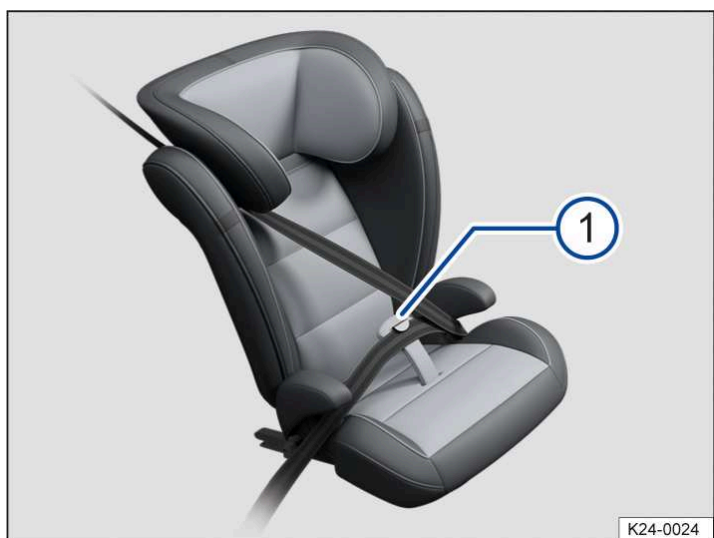
Илл. 2 Детское сиденье с дополнительной направляющей ремня (условное изображение).
