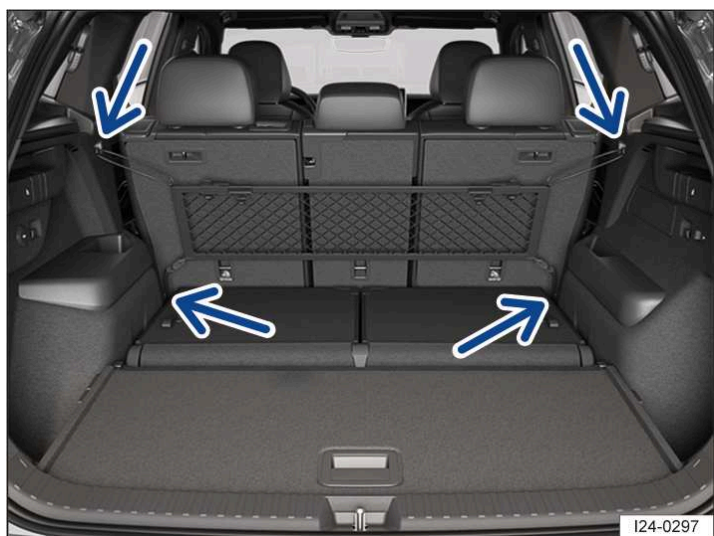
Илл. 2 В багажном отсеке за вторым рядом сидений: подвесная боковая сетка.
