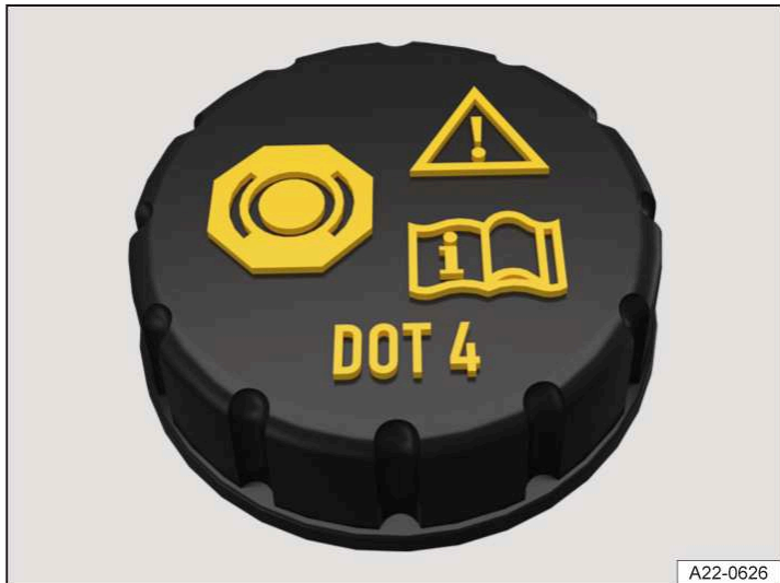
Илл. 1 В подкапотном пространстве: крышка компенсационного бачка для тормозной жидкости.
