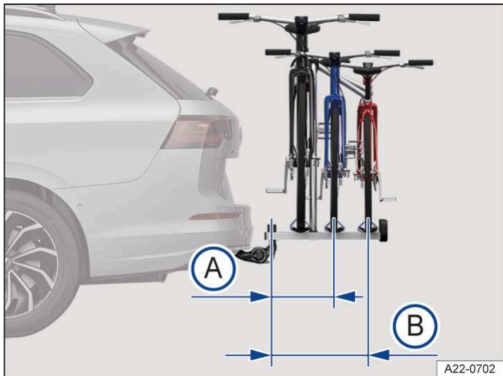
Илл. 2 Условное изображение максимального вылета крепления для двух или трёх велосипедов
