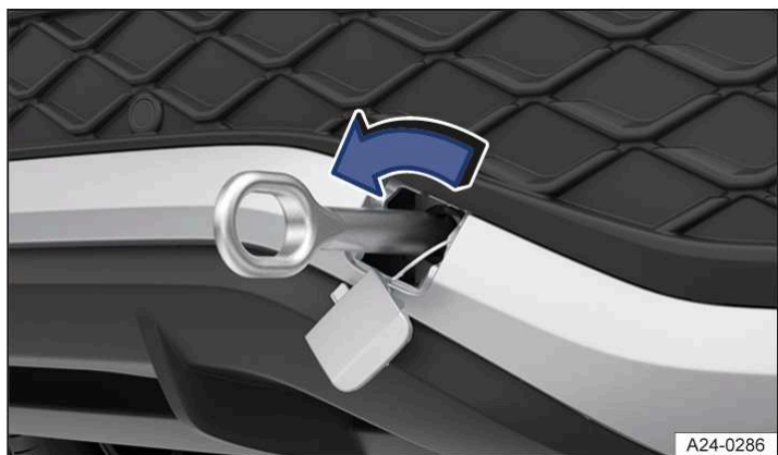
Илл. 2 На заднем бампере справа: вкрутите буксирную проушину.
