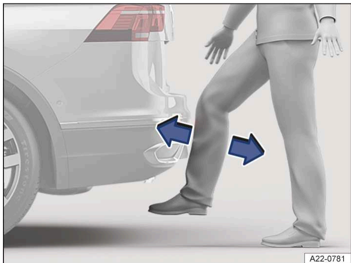
Илл. 1 Условное изображение крышки багажного отсека с открыванием по сигналу датчика (Easy Open)
