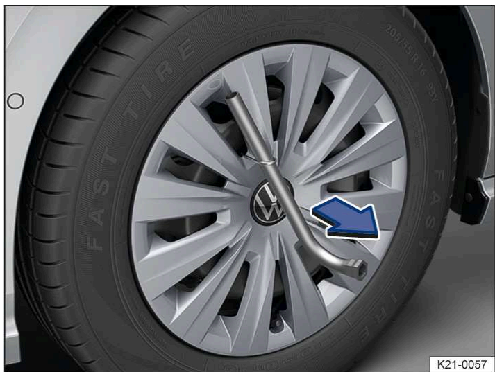
Илл. 1 Снятие полноразмерного колёсного колпака
