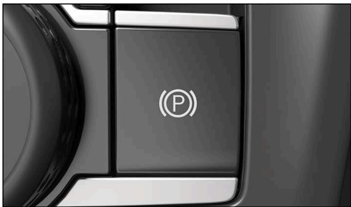
Илл. 1 На центральной консоли: клавиша электромеханического стояночного тормоза
