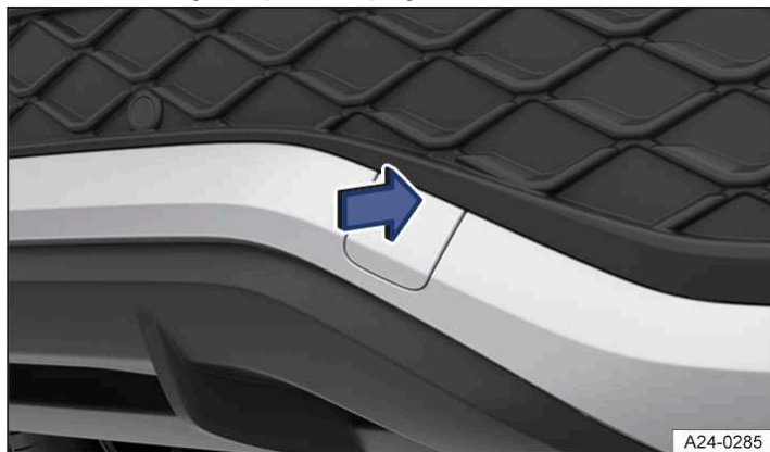
Илл. 1 На заднем бампере справа: снимите накладку.
