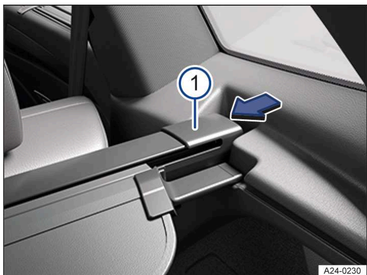
Илл. 1 В багажном отсеке: снятие шторки багажного отсека
