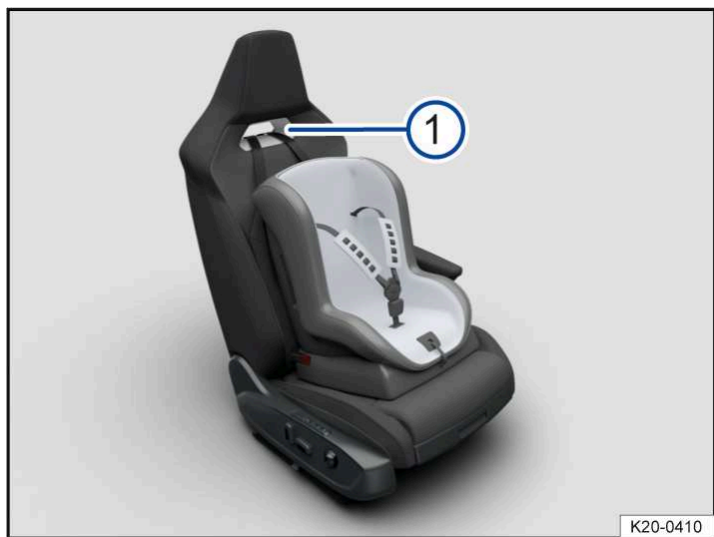
Илл. 4 В спинке высококлассного спортивного сиденья (с отверстием) на стороне переднего пассажира: отверстие для ремня Top Tether (условное изображение).
