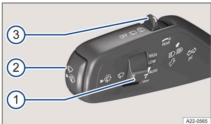
Илл. 1 Слева на рулевой колонке: переключатели указателей поворота, дальнего света и стеклоочистителя.
