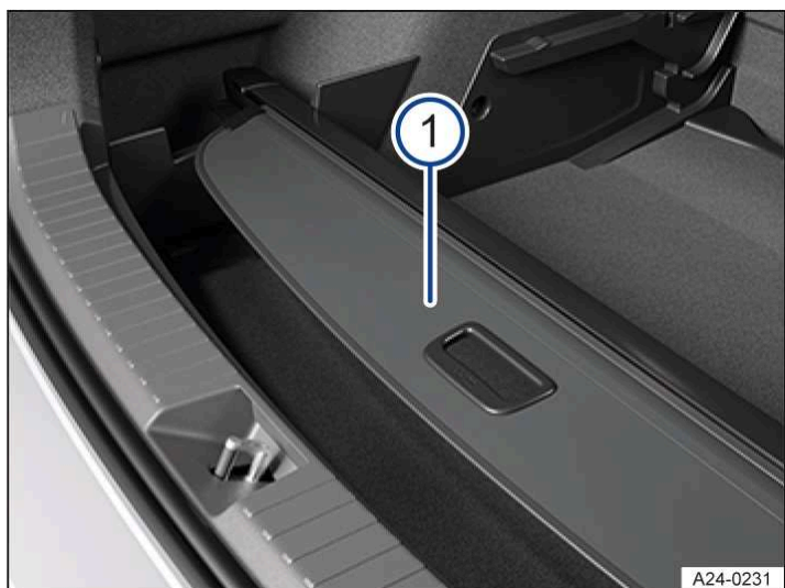
Илл. 1 Под фальшполом: размещение шторки багажного отсека
