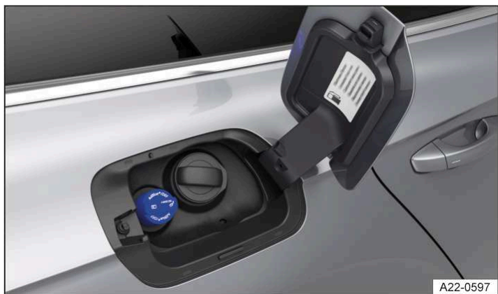
Илл. 1 Под крышкой лючка заливной горловины: пробка заливной горловины для жидкости AdBlue (условное изображение).
